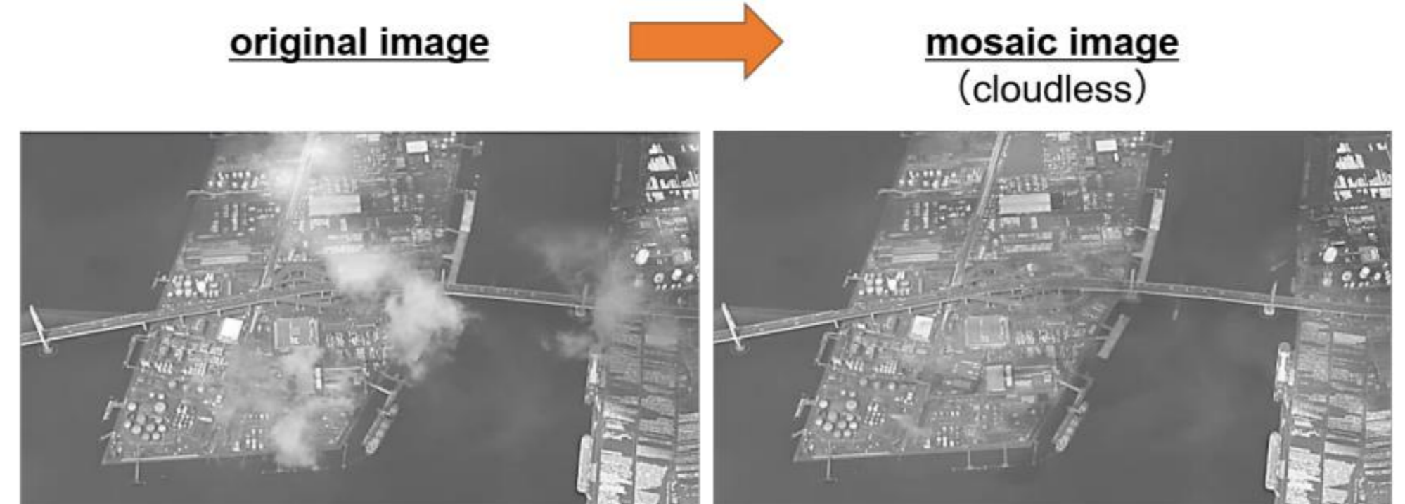
雲除去処理のシミュレーション 連続画（左）を複数枚合成することで、雲を除去した画像を作成可能になる。このサンプルでは6枚の画像を合成した。雲除去画像は、同一視野を時間連続的に観測できる静止光学衛星の特長を活かしたプロダクトとなり得る。
