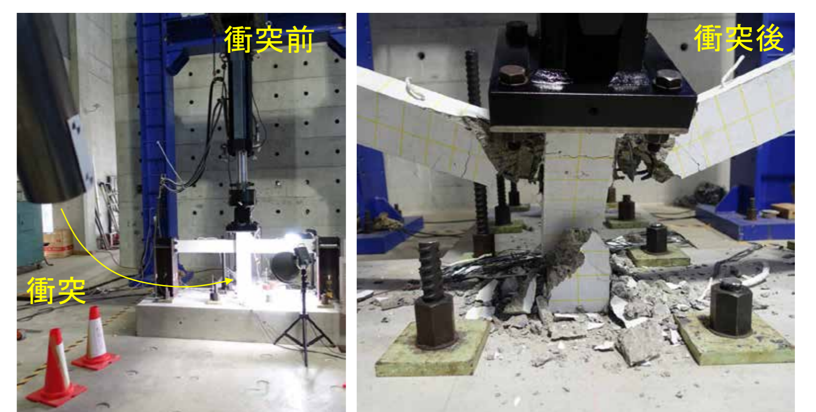
鉄筋コンクリート造架構への模擬船舶の衝突実験
