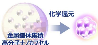
ナノカプセルを用いる鑄型合成法
