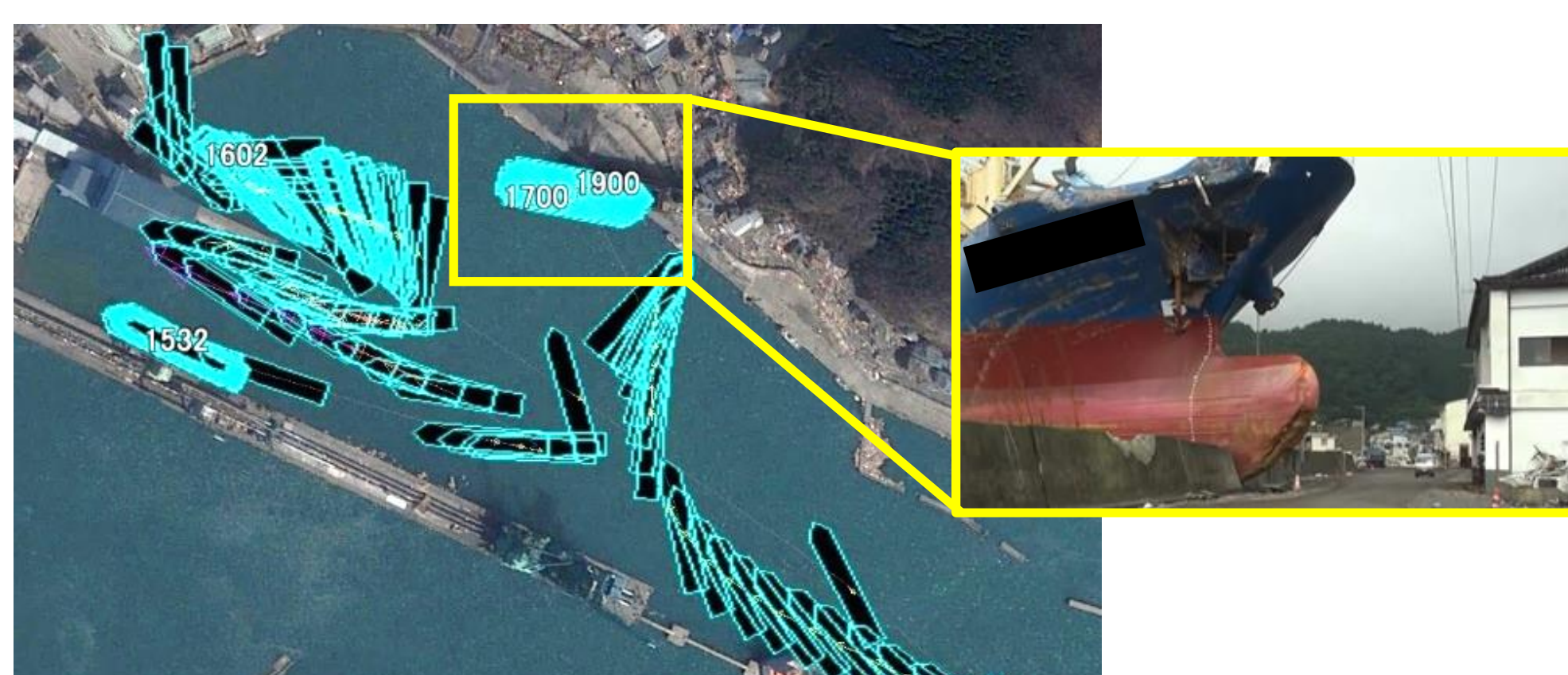
津波により漂流した船舶の挙動データと座礁の様子
