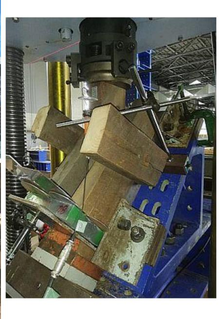
図明治神宮旧鳥居の強度測定(2023)
