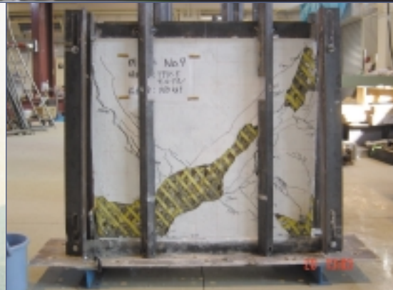
組積造建物の耐震補強構法に関する実験
