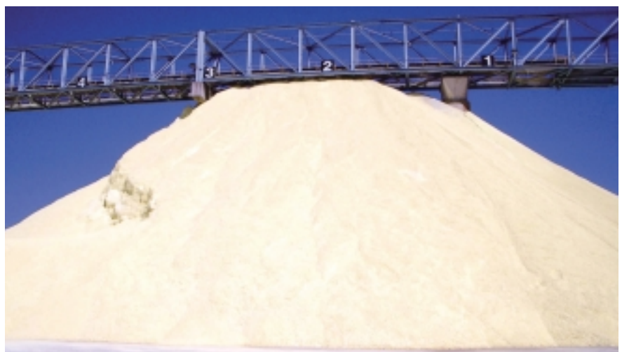
巨大なイオウの山。原油からの脱硫により膨大な量のイオウが生成するが、現状では使い道が少なく山積されている。
