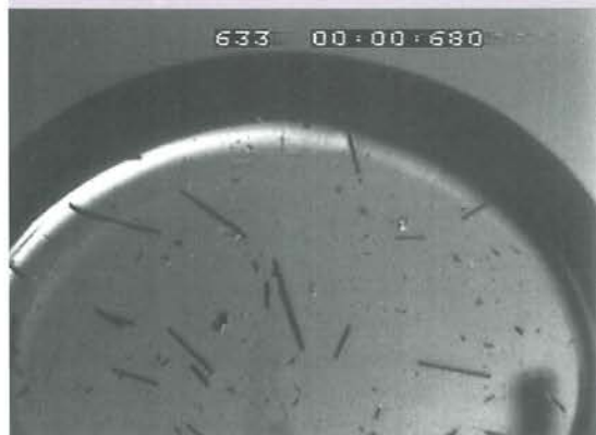
写真1 ゲート近傍でのガラス繊維配向過程の可視化
