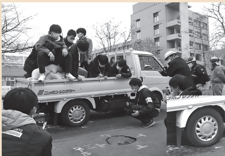
実物大試験道路における陥没試験(車両後輪直下に空洞あり)
