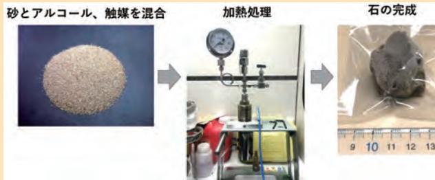
図3：砂同士を直接接着して作製した硬化体
