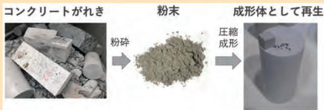
図1：コンクリートがれきを粉碎、圧縮成形して作製した成形体
