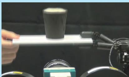
図1 板の傾きを計測して、板が常に水平になるようにロボットは板を操作する
