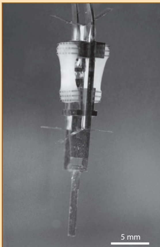
拮抗筋構造を有するバイオハイブリッドロボットの外観
