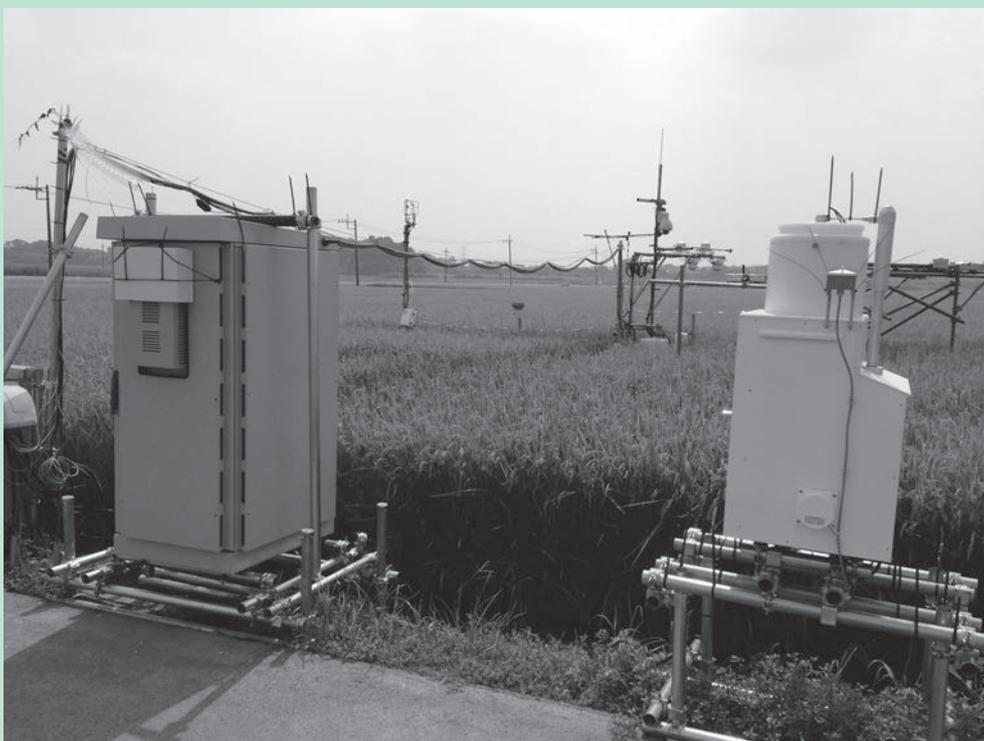
つくば市真瀬の試験水田に設置した水安定同位体比連続観測システム全景。左側の装置が水蒸気同位体比測定装置で、写真中央付近の水田内に設置された柱から水田上空の水蒸気を装置に送り込み、2秒に一度の間隔で水蒸気同位体比を測定する。右側の装置は降水サンプラーで、降水が検出されたときのみ上部の蓋が開き、一定時間ごとの降水を内蔵した16本のボトルに分けて採取する。
