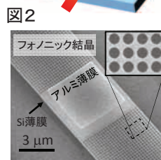
図1(a, b) シリコン薄膜とそれに周期的な孔をあけたフォノンニック結晶中の熱流イメージ。孔をあけて熱を通しやすくするという直観と反したことも実現可能。図2 作製したシリコンフォノンニック結晶の走査型電子顕微鏡写真。光を使って非接触でナノ構造の熱伝導率を測ることができる。
