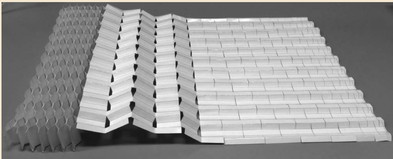
シートから翼型ハニカムを折る様子。製造したい断面形状を基にスリットの形状、位置を計算することで、任意の断面のハニカムコアパネルを立体化できる。
