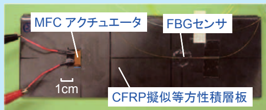
図 1 CFRP 積層板と一体化した広帯域超音波伝播システム
