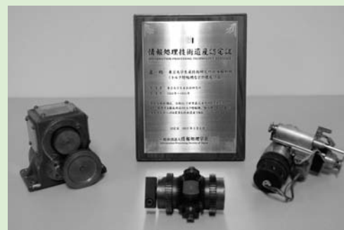
情報処理技術遺産認定証とトルク増幅機などの構成部品(左側から、トルク増幅機、加算機、曲線追尾用光学ヘッド)
