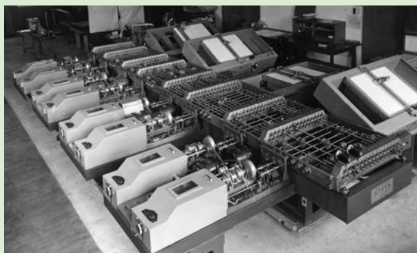
完成直後の微分解析機(於、生研西千葉キャンパス)
