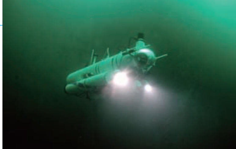
釜石湾口防波堤を観測するため降下中のトライドッグ1号
