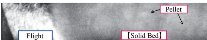
スクリュ供給部における拡大観察 (材料；ガラス短繊維強化PP)
