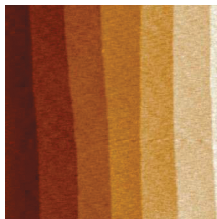
PLD法により室温で成長したGaNのAFM像
