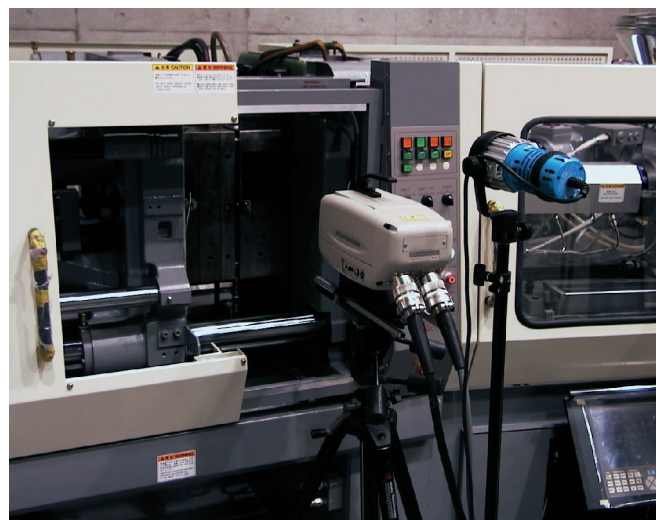
型内充填挙動の直接観察
