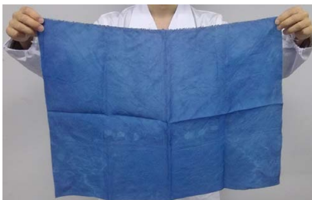
図 1. 開発した吸着材（プルシアンブルーを新規手法で繊維に固定したもの）
