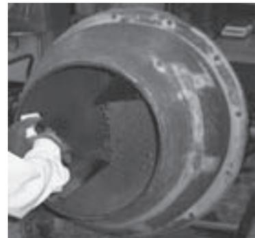
写真1 傾胴式ミキサを用いた転動式造粒
