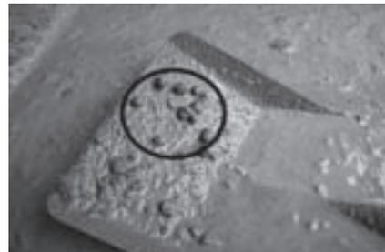
写真3 荷卸後のコンクリート中の造粒物の状態
