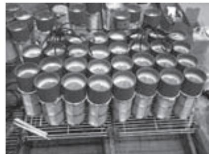
写真4 円柱供試体を用いた通水試験の様子
