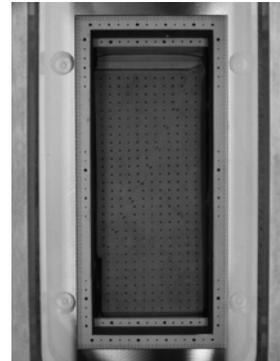
写真2 供試体側面の変形状況の例
