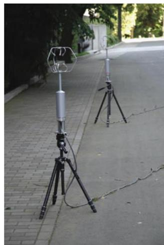
写真2 風速の計測実験
