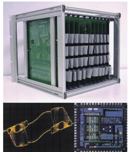
写真1 神経モデルのアナログ回路
