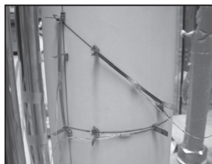
写真1 円筒供試体に PLDT を装着した様子
