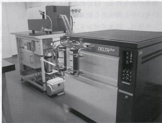
図1 安定同位体比測定装置
