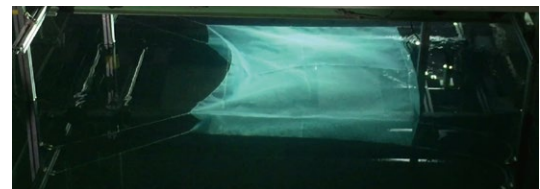
風路付き造波回流水槽における生簀網の抵抗試験 Drag test of cage netting at circulating water channel
