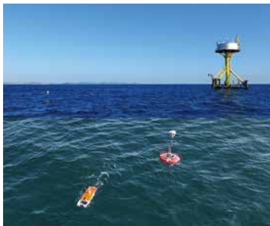
平塚沖総合実験タワーと測位支援用ブイ・小型AUVによる海中観測プラットフォームシステム Hiratsuka Offshore Experimental Tower and Underwater Observation Platform System with Positioning Support Buoy and Small AUV
