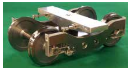
教材用鉄道台車 縮尺=1/8.4 Bogie for teaching materials scale=1/8.4
