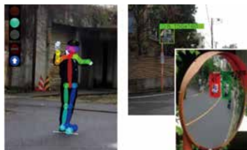
自動運転車の運行設計領域の拡大に向けた 手信号の理解や死角の危険予知 Towards wider ODD: Hand signal recognition and risk prediction in blind spots
