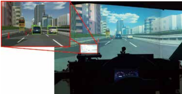
ドライビングシミュレータを用いた運転支援用HMIの評価 Evaluation of Human-Machine-Interface for driving assistance using a driving simulator
