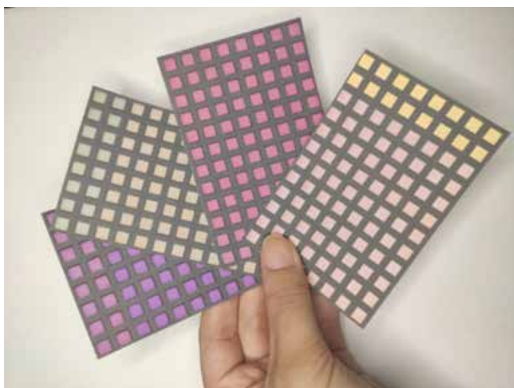
その場分析を指向した紙基板型比色センサレイ Paper-based colorimetric chemosensor array toward on-site analysis
