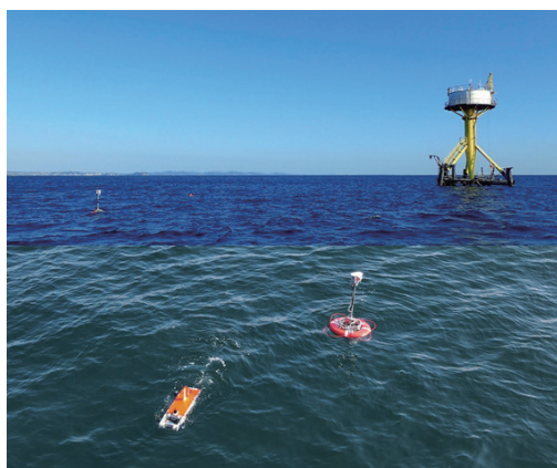
平塚沖総合実験タワーと測位支援用ブイ・小型AUVによる海中観測プラットフォームシステム Hiratsuka Offshore Experimental Tower and Underwater Observation Platform System with Positioning Support Buoy and Small AUV
