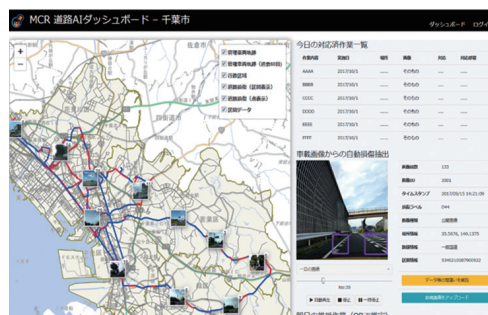
道路画像損傷自動抽出によるリアルタイムデジタルツインの取組 Development of real-time digital twin using automatic road damage image extraction function
