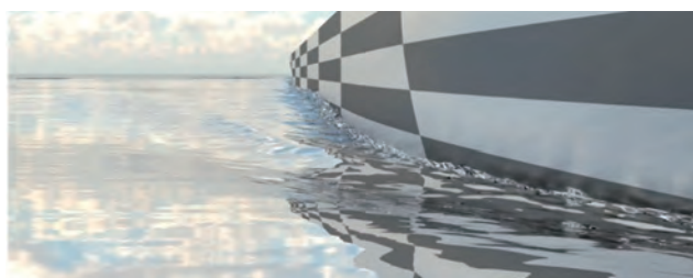
船体まわりの乱流境界層と造波の数値シミュレーション （画像提供：一般財団法人日本造船技術センター） Numerical simulation of hull boundary layer and wave resistance (Courtesy of Shipbuilding Research Centre of Japan)
