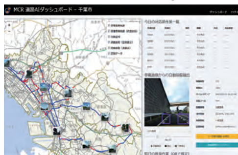
道路画像損傷自動抽出によるリアルタイムデジタルツインの取組 Development of real-time digital twin using automatic road damage image extraction function
