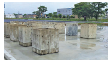
自己治癒コンクリートの暴露試験 Exposure test of developed self-healing concrete
