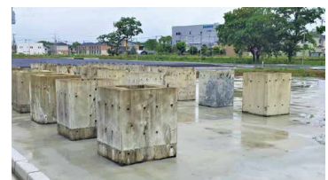
自己治癒コンクリートの暴露試験 Exposure test of developed self-healing concrete
