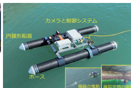
海洋構造物周辺の生態系調査 MMC(Multi Mover Catamaran)を開発しました。
