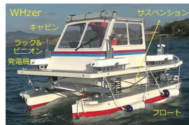
Wave Harmonizer (山口県油谷湾・神奈川県平塚沖) 小型波で波エネルギーを収穫して乗り心地を向上しました。
