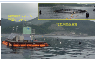
可変深度型生簀と自動給餌システム (宮城県女川湾) 任意の深度に設置できる可変深度型生簀を開発しました。
