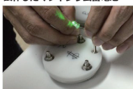
試作したマグネシウム蓄電池
