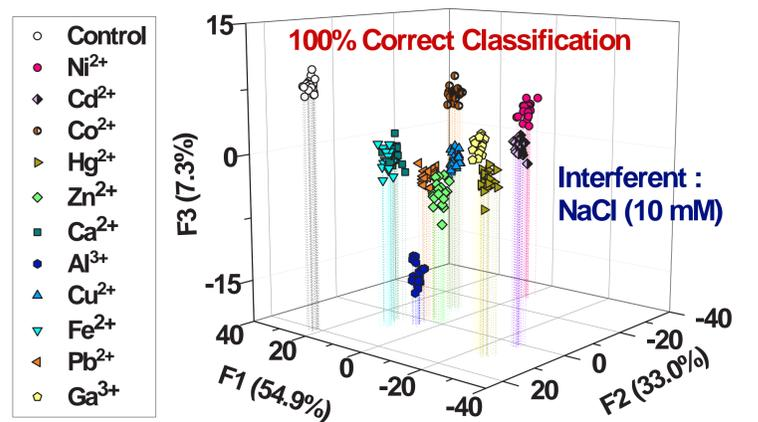
例：自己組織型比色ケモセンサアレイによる金属イオン類の同時定性分析
