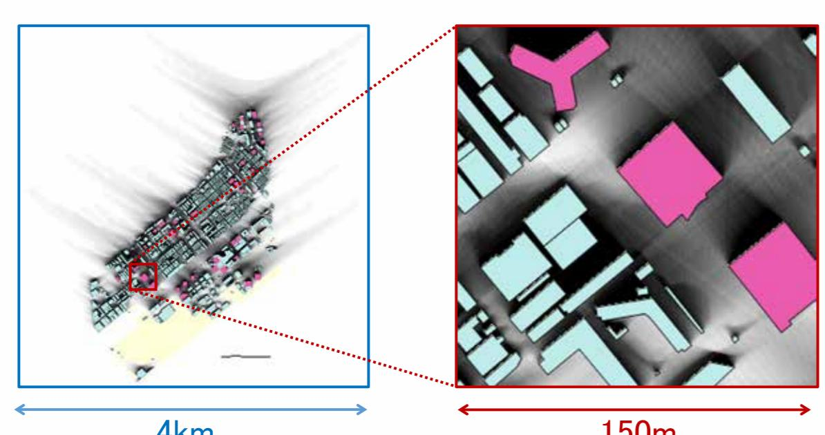
タワーマンションなど超高層建築物の影は、ときに長さが1km以上になり広範囲に影響を与えます。本研究では、4千以上の建物データと16万候補点を実装した解析システムで、複合日影の特徴を把握します。
