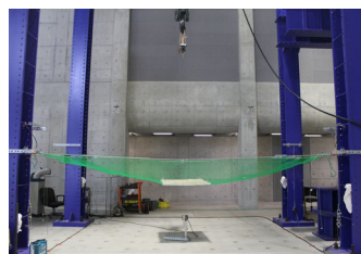
落下防止ネットの実大実験
