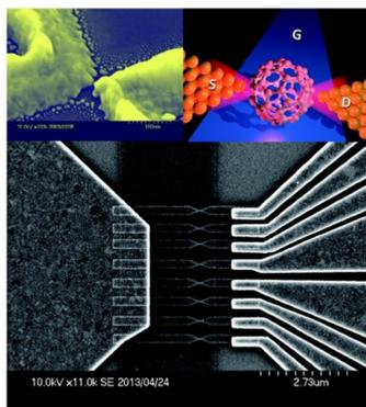
原子スケールのギャップを有する電極で
