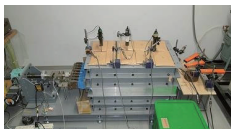
新素材を用いた補強土擁壁の耐震性に関する研究 補強効果を引抜き試験と振動台模型実験で検討
