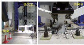
鉄筋コンクリート造架構への模擬船舶の衝突実験
