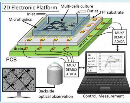
ALSのメカニズム解明の為に液晶ディスプレイのTFTプラットフォームを用いたμTAS (Micro Total Analysis Systems)
