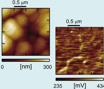
Cu(In,Ga)Se<sub>2</sub>太陽電池の形状像 (左) と光起電力像 (右)
