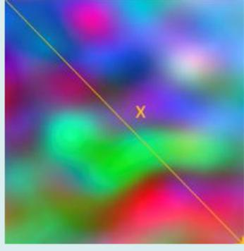
化学コントラストを有する原子間力顕微鏡 (カラー-AFM) で取得したシリコンの像
