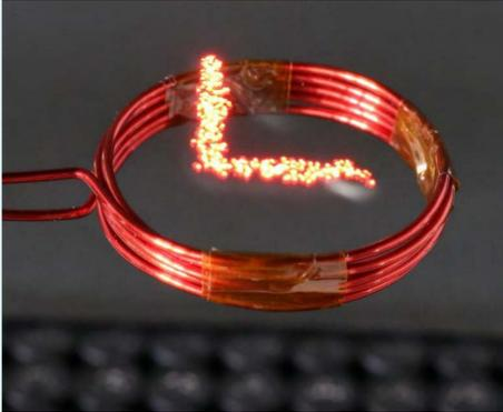
空中ディスプレイ向けの空間を飛び回る直径4mmのLED光源
