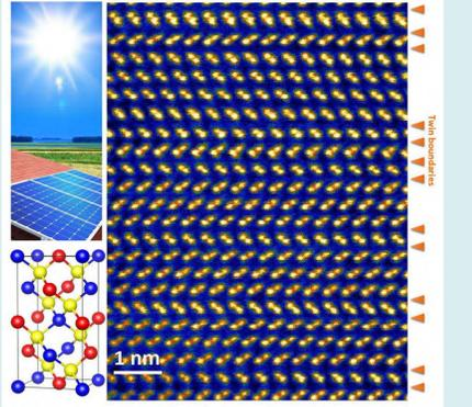
太陽電池光吸収層におけるマルチプル双晶の原子分解像
