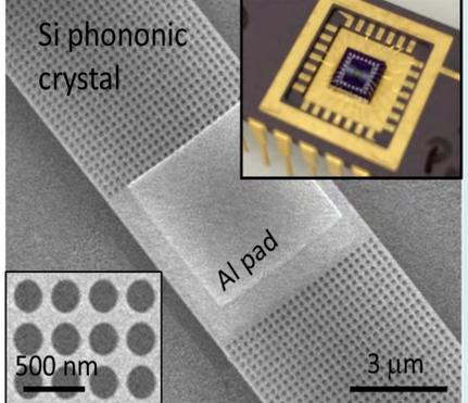
ナノ構造シリコンを用いた熱電変換エネルギーハーベスタ
