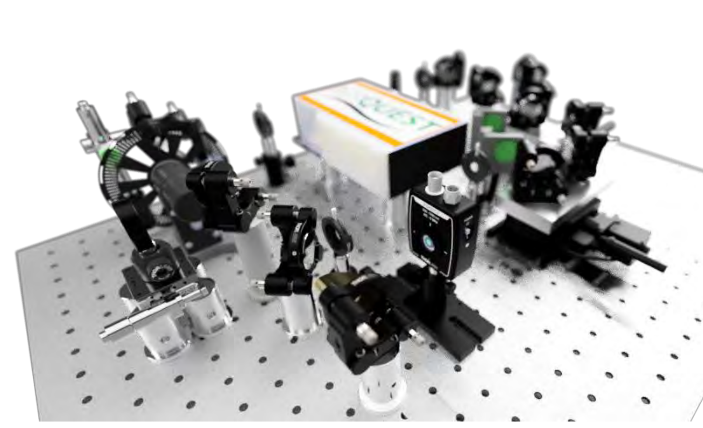
赤外域の広いスペクトル・電場振動6サイクルのパルス幅を計測
