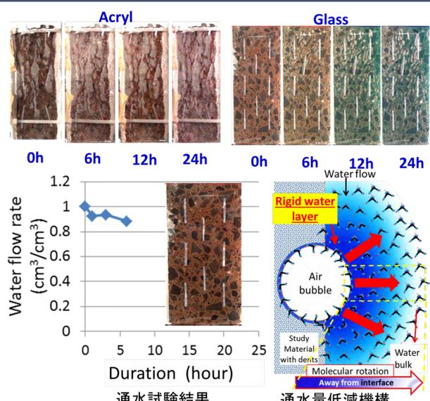
ひび割れ内に生成された気泡による通水量の低減機構の解明
