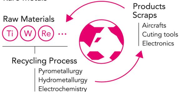
構造材として需要の増大が見込まれるチタン、工具材料として欠かすことができないタングステンとコバルト、ニッケル基超合金に使われるレニウム、自動車排ガス浄化触媒に含まれる白金族金属などに注目し、新規な高効率かつ環境調和型のリサイクル技術の開発を行っています。
