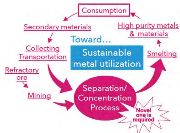
廃棄物や鉱石を固体のまま分選濃縮する省エネルギー型プロセスの研究開発を行っています。このような固体分選濃縮技術は、高温や薬剤で溶かして高純度の金属を生産するプロセスの「前処理」あるいは「中間処理」に位置しています。
