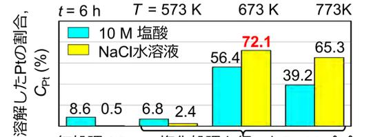
無処理のPt 塩化処理を行ったPt-Mg合金 ⇒ 塩水への溶解率“70%以上”を達成
