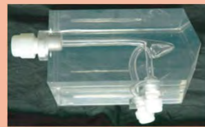
脳動脈瘤の実血管形状モデル 動脈瘤内の流れ
