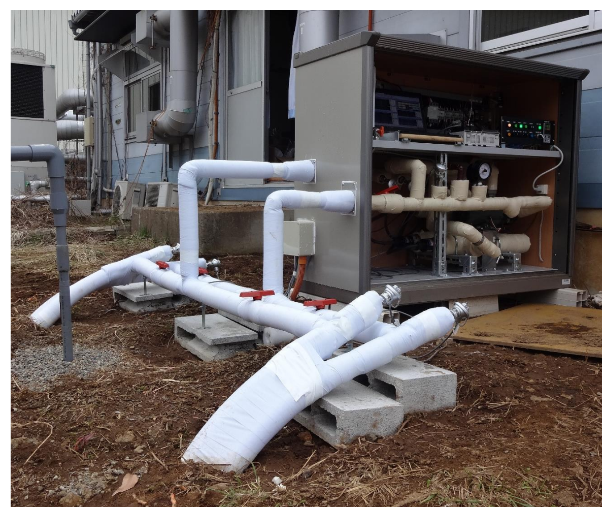
■ 地中の熱伝導率を同定するための熱応答試験
