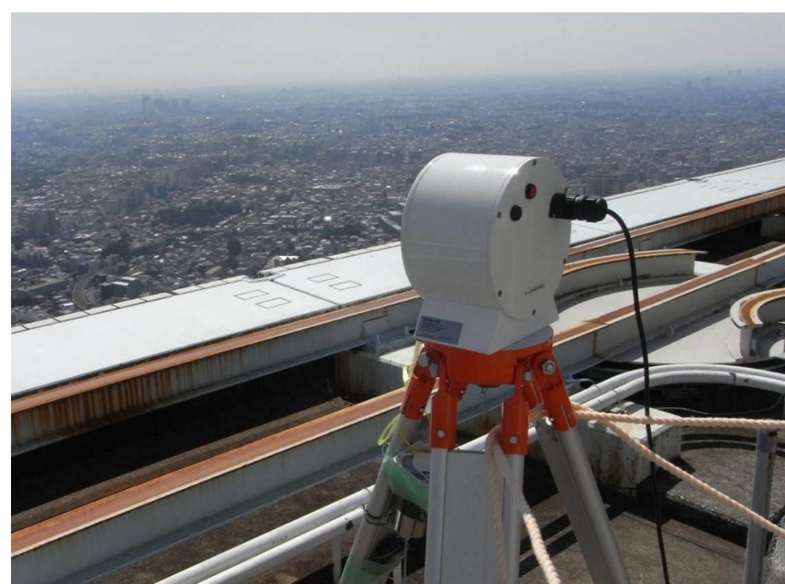
■ シンクロメータを用いた都市域の顕熱フラックス実測
