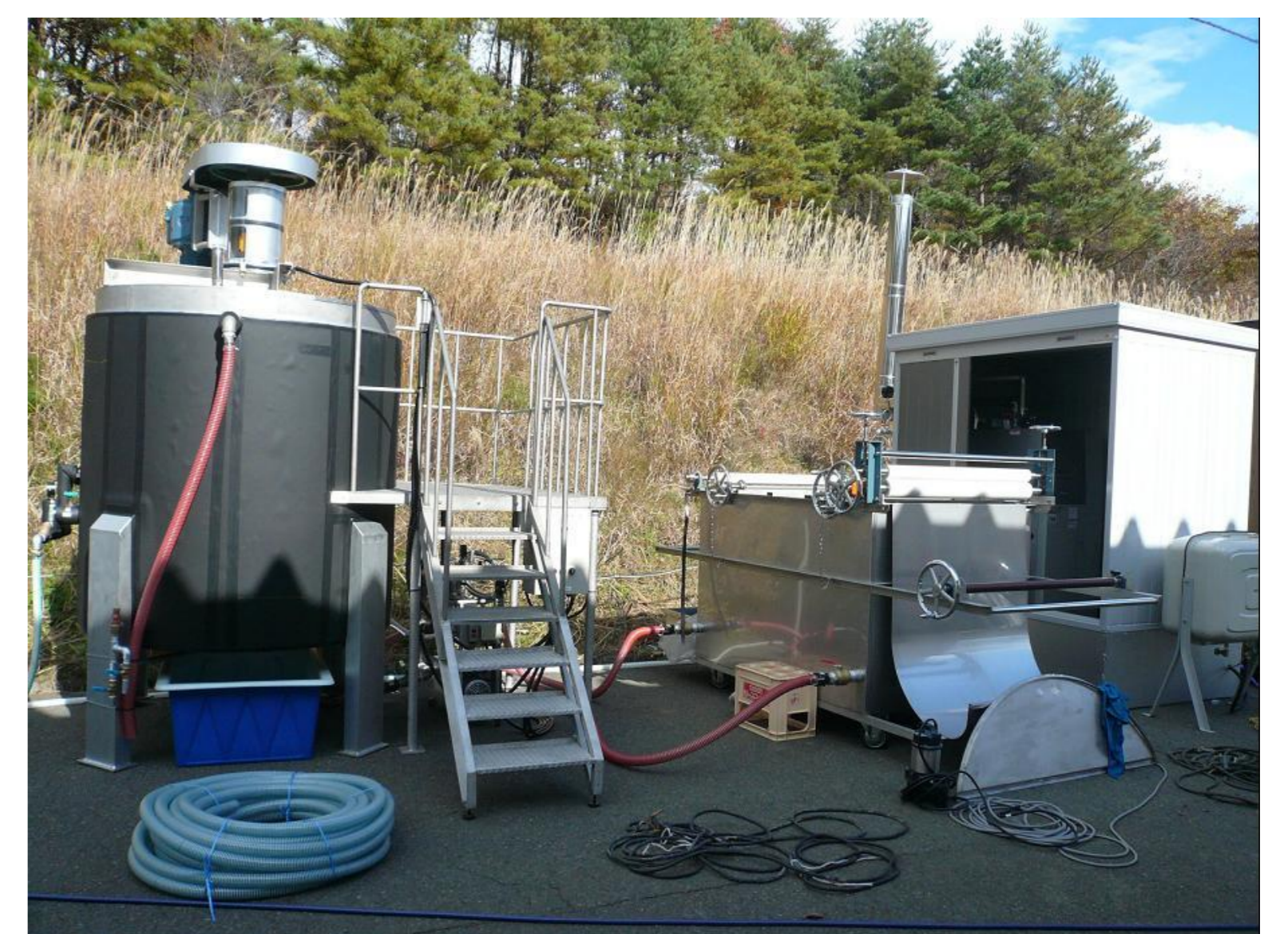
プルシアンブルーを利用した土壌からの放射性セシウム除去装置
