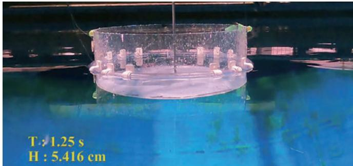
海上半閉鎖循環式養殖システムの生簀運動の水槽実験
