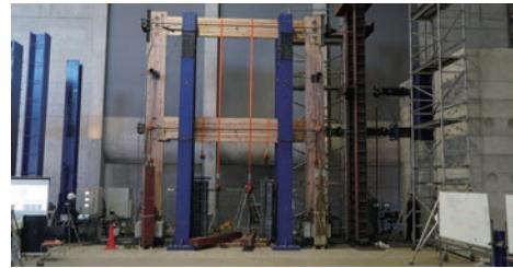
静的載荷関連設備および反力壁
